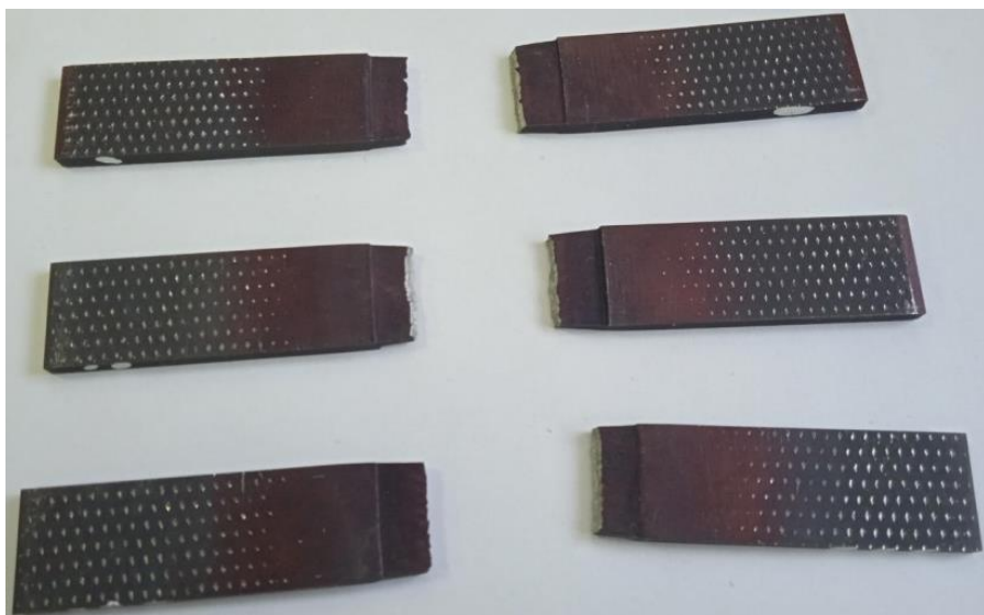
Образцы после испытаний на растяжение со снятым усилием
